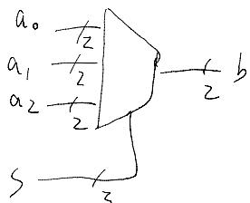
module Mux3\_2(a2, a1, a0, s, b);
